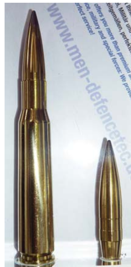
Riesenbaby: Die Firma MEN stellte ihren neuesten Sprößling in der Sniper Line im Kaliber 12,7x99 vor. Das 768 Grains schwere SAPI (Solid-Armour-Piercing-Incendiary) Projektil soll mit seinem Hartkern auf 1.100 Metern sogar noch 10 Millimeter Panzerstahl durchschlagen.
