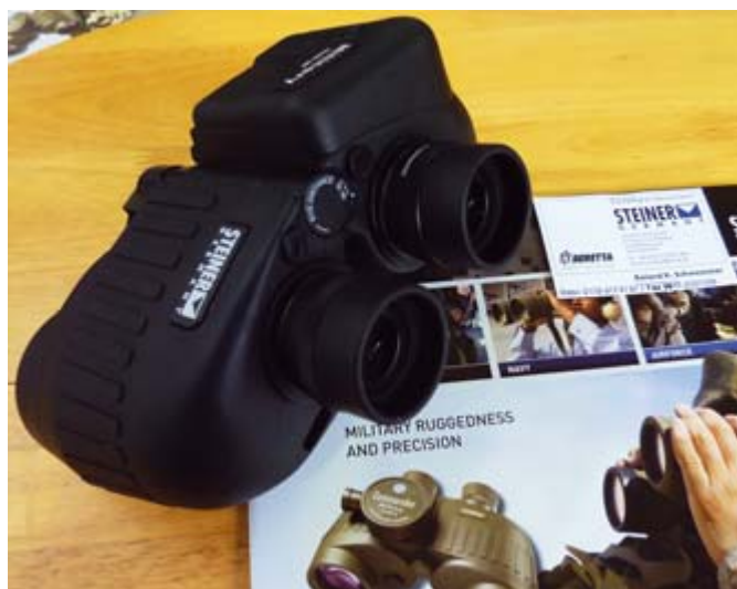
Das neue Steiner Military 10x50 LRF vereint eine leistungsstarke Beobachtungsoptik mit Laserentfernungsmesser und verspricht dabei Messungen bis zu 1.500 Metern.
