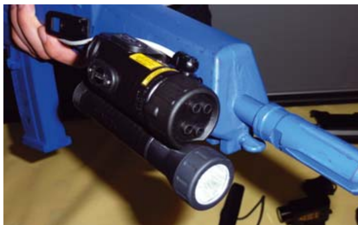
Der Name ist Programm. Das "Vario Ray" der Firma Rheinmetall vereint Licht, IR-Strahler, Rotpunkt und IR-Laser und verfügt zudem noch über ein Freund-Feind-Erkennungssystem. In der Dunkelkammer konnte man das Multifunktionsgerät selbst ausprobieren.
